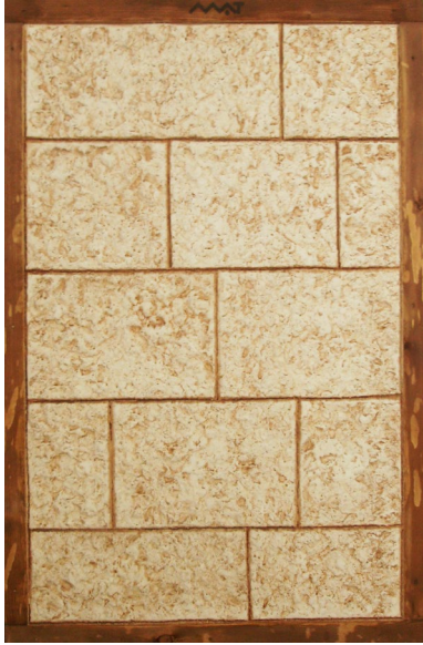
ローラー：ピシャンストーン バーチカルワークフィラー：ベースホワイト カラー顔料：なし カラーリリーサー：ブロンズ
